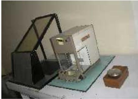
Fig. 2. Semimicro-balance apparatus.
