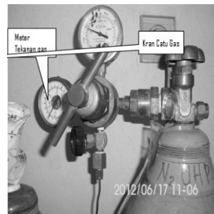
Gambar 4. Kran catu gas Nitrogen ke alat.
