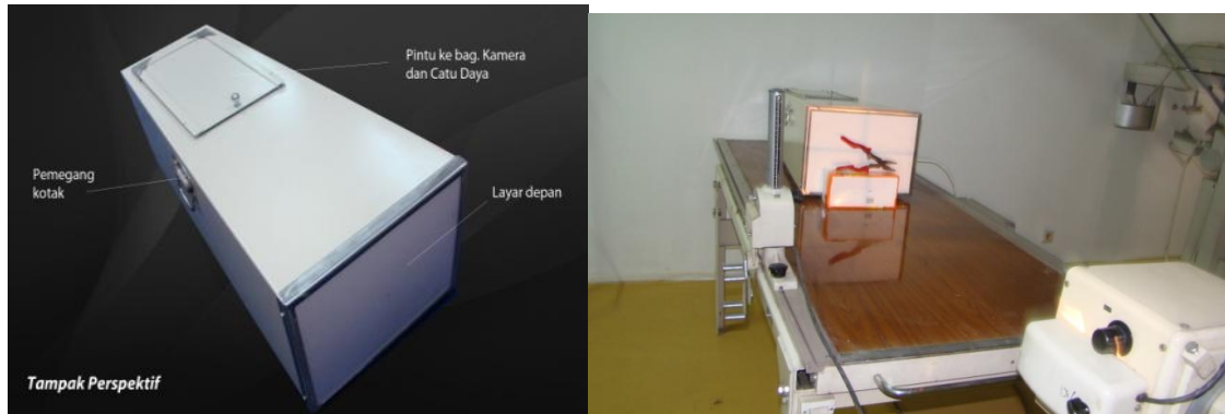
Gambar 2 Modul Penangkap Citra Sinar-X dan Tata Letak Pengujian
