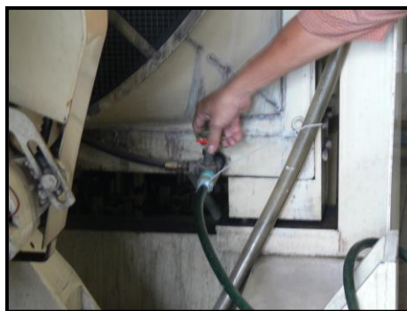
Gambar 3. Penggantian air radiator
