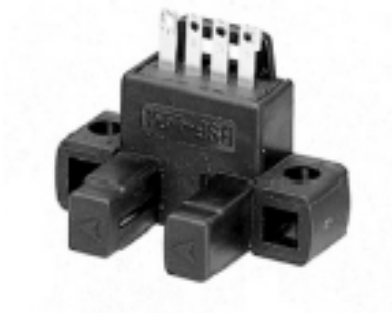
Gambar 4. Komponen yang ditambahkan berupa optocoupler
