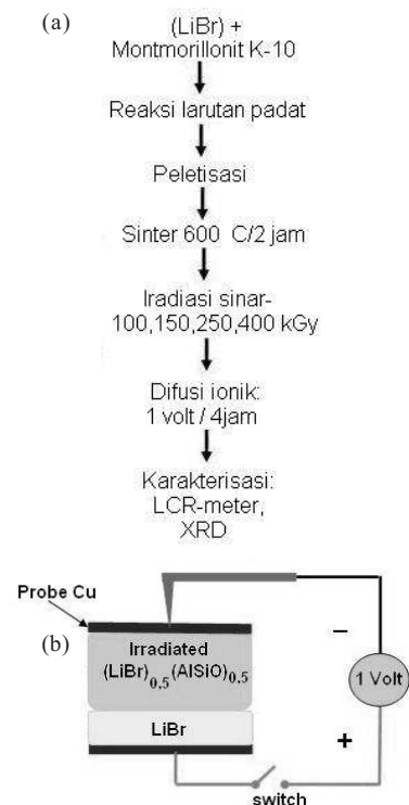
Gambar 2. (a). Diagram alir pembuatan bahan konduktor super ionik (\text{LiBr})_{0,5}(\text{montmorillonite K-10})_{0,5} dan (b). Proses difusi ionik pada tegangan listrik DC sebesar 1 volt selama 4 jam
