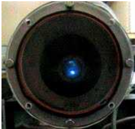
Gambar 5. Pengujian timbulnya spot plasma sebagai pemicu terjadinya plasma, telah terjadi spot plasma pada permukaan katoda yang berupa lingkaran kecil berwarna putih.
