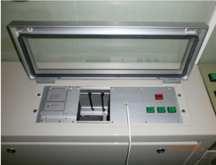
Gambar 8. Hasil instalasi akhir pembuatan perangkat kendali gamma scanning
