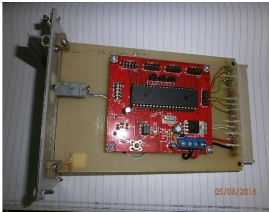
Gambar 6. Hasil perakitan modul mikrokontroller
