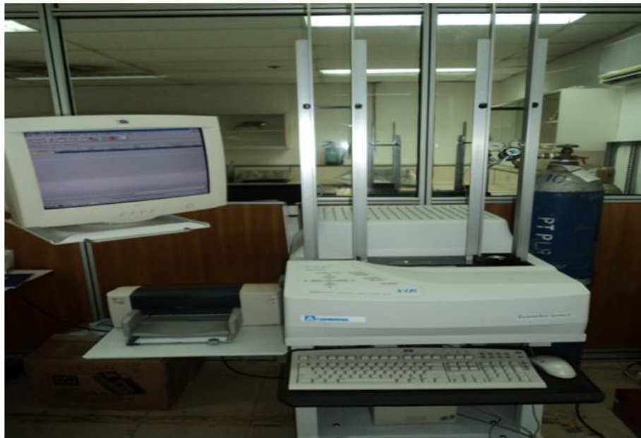
Gambar 2. Peralatan alpha, betha counter untuk analisis dosis internal dengan invitro
